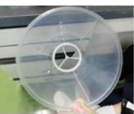
写真5 濃硫酸でとけた ポリエステルのフィルター
